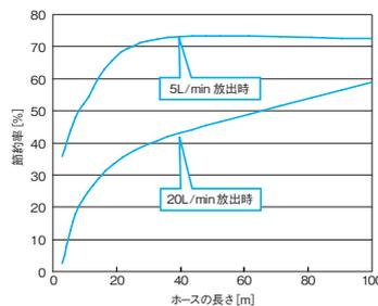
[備考] ■節約率は、使用流量、ホースの長さ、溶接サイクル等のご使用条件により変化します。
